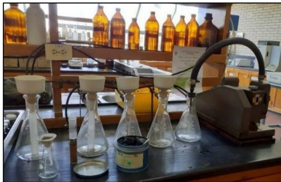
**Figura 9. Embudos de cerámica y extractor para digestión de muestras en el laboratorio.**
