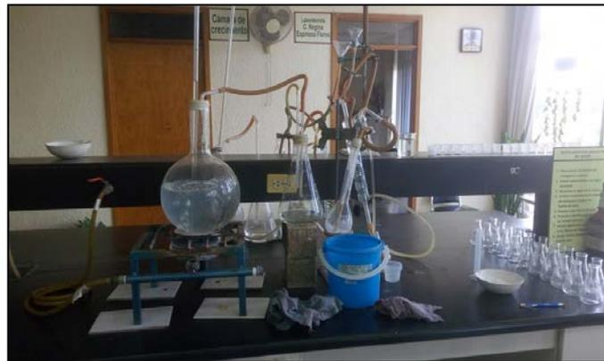
**Figura 8. Método de microkjeldahl para la determinación de nitrógeno.**
