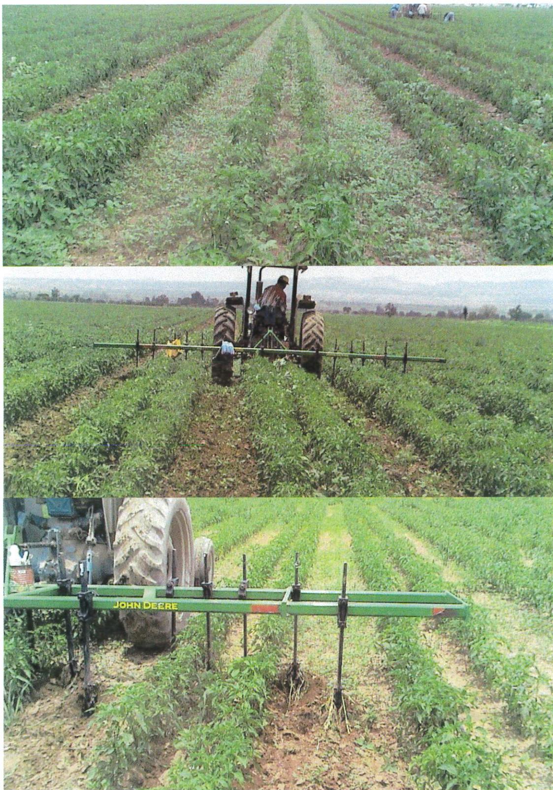
Figura 13. Cultivo posterior de chiles en camas bajas a doble hilo con la cultivadora de doble barra. El cultivo elimina la maleza y permite la oxigenación de las raíces.
