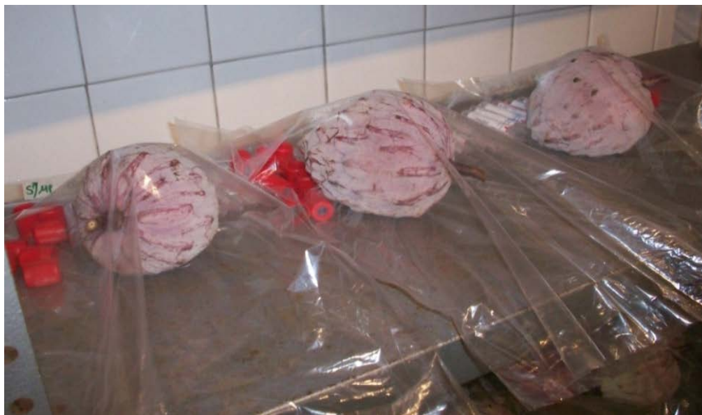
Figura 11. Unidades experimentales con distintos tratamientos de microperforado y serie de 12 tubos para muestreo de atmósfera instalada en condición térmica de 20°C.
