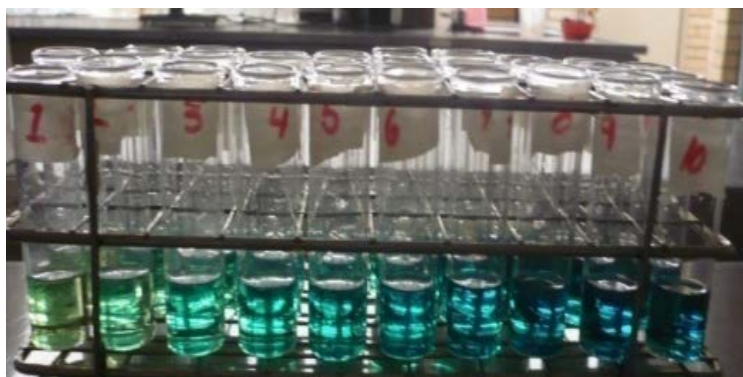
Figura 12. Reacción ácida colorimétrica con 10 puntos de dilución de solución estándar de glucosa (15 mg/100 mL) con reactivo antrona.
