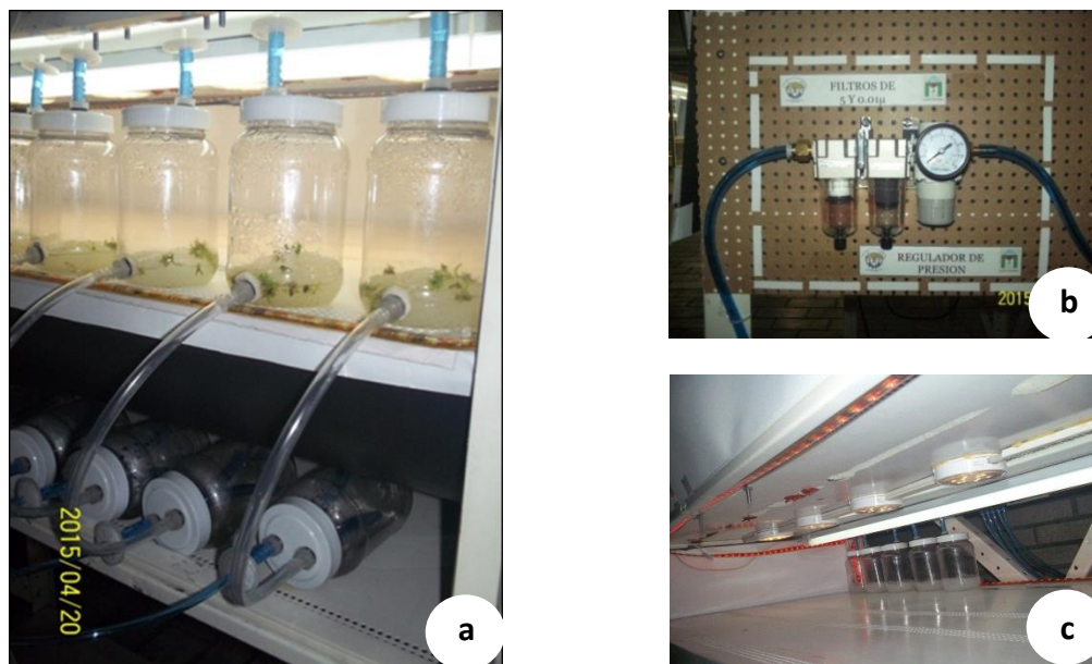
Figura 26. Prototipo de inmersión temporal, a) BioEdUACH b) sistema neumático, c) sistema de iluminación.
