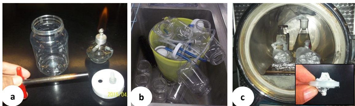
Figura 19. BioEdUACH, a) apertura de orificios a los frascos con calor, b) lavado y escurrimiento de todos los componentes, c) autoclaveado de los fitting y filtros 0.2 \mu m.
