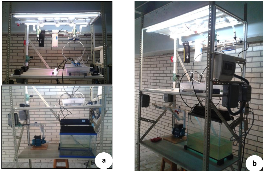
Figura 16. Prototipo biorreactor, Vista; a) frontal del Nivel inferior y superior (1m de alto cada uno), b) lateral.
