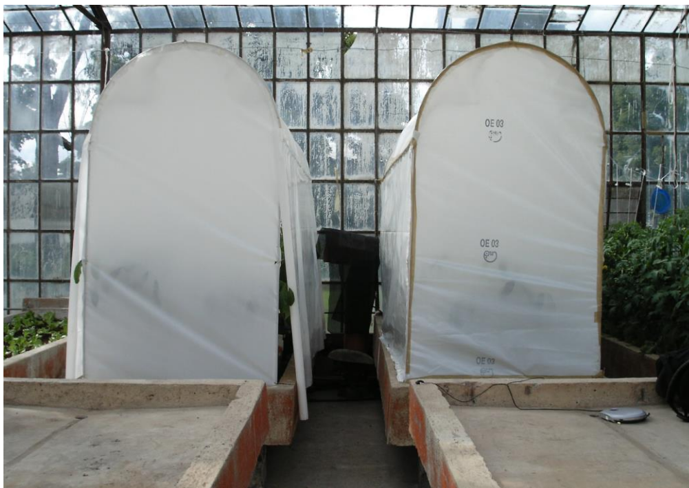
Figura 1. Cámara plástica con cierre hermético para mantener alto el nivel de CO 2 , ubicada en el invernadero del Departamento de Suelos en la Universidad Autónoma Chapingo.
