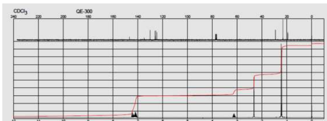
Figura 11. Espectro de Resonancia Magnética Nuclear de ^1\text{H} (Trazo inferior) y ^{13}\text{C} (Trazo superior) del o-cimeno 1 (RMN ^1\text{H} 300 MHz y ^{13}\text{C} 75 MHz, \text{CDCl}_3 , TMS).
