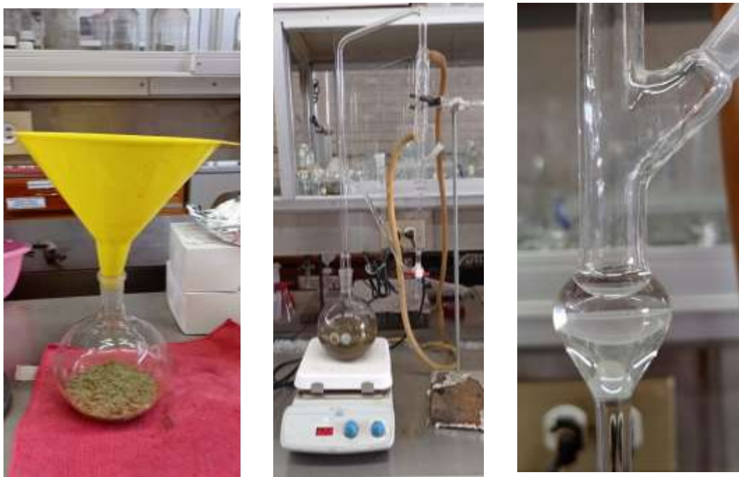
Figura A 4. Extracción de aceite esencial con equipo Clevenger.
