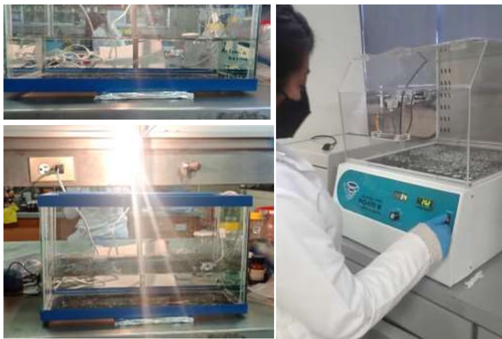
Figura 8. Eclosión de larvas de Artemia salina por 24 horas e incubación de larvas en equipo Incubadora de mesa con agitación orbital modelo INO 650M.
