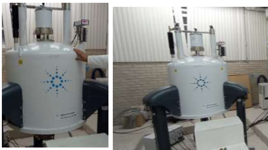
Figura 5. Espectrómetro de RMN de 400 MHz Agilent DD2 disponible en el Laboratorio de Productos Naturales UACH.
