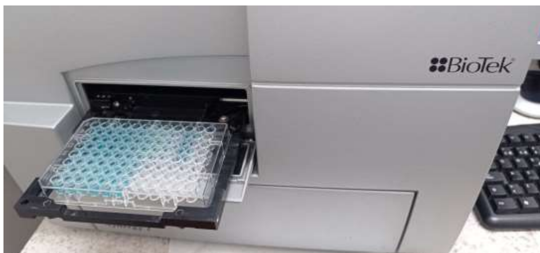
Figura A 6. Lector de microplacas: Marca BioTek para medidas de actividad lumínica.
