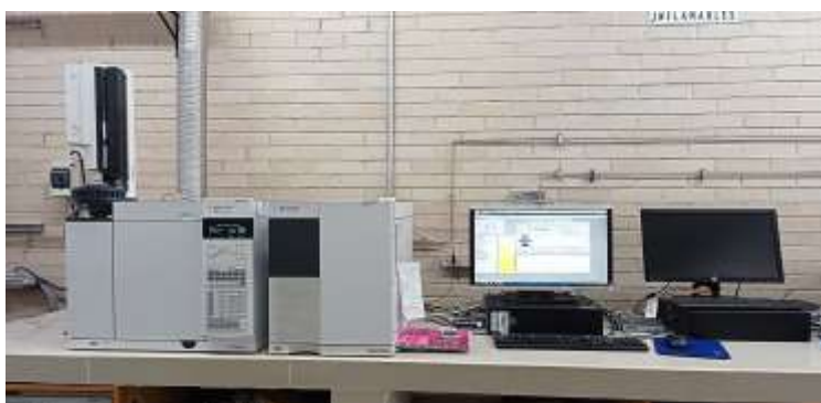
Figura 9. Cromatografo de Gases Acoplada a Espectrometría de Masas disponible en el Laboratorio de Productos Naturales UACH.
