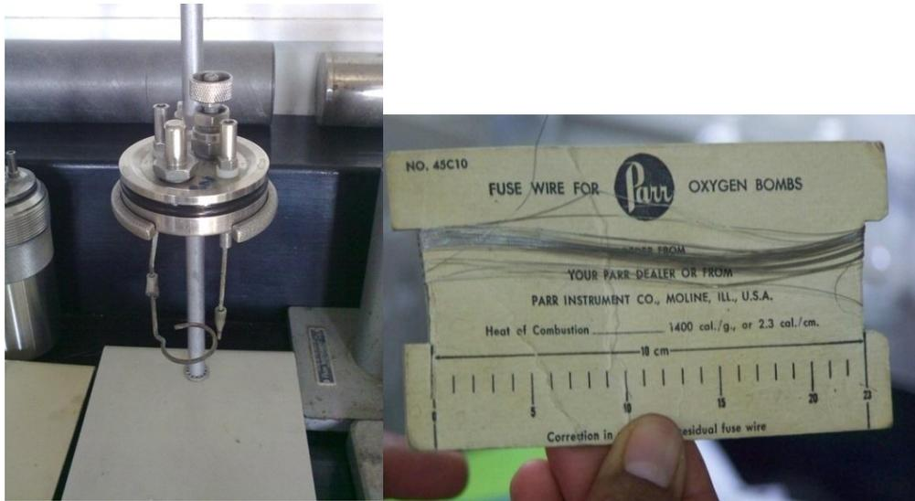
Figura 6. Colocación del alambre y montaje de la muestra en el soporte.
