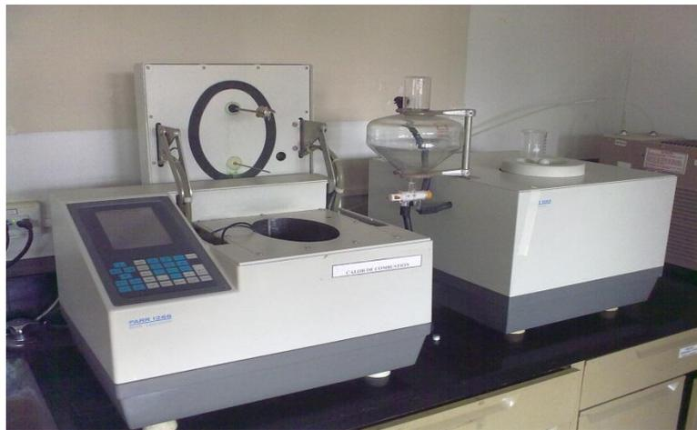
Figura 7. Equipo para la obtención del calor de combustión (calorímetro isoperbólico).
