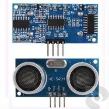
Cuadro 6. Características técnicas Sensor ultrasónico HC-SR04.
