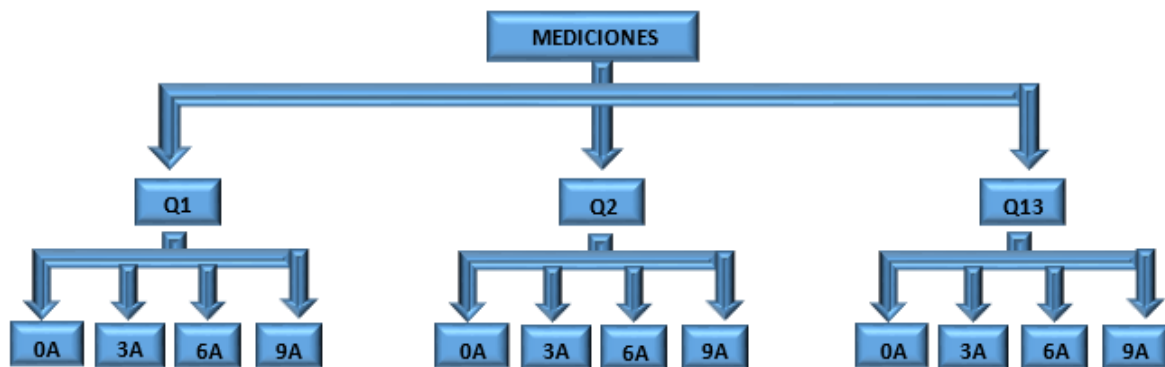
Figura 14. Esquema de mediciones de tirantes para flujo gradualmente variado.
