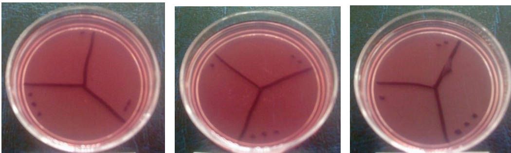
Fig. 35. Hipoclorito de sodio a 500 ppm. No se observa crecimiento microbiano a las 72 horas de incubación a temperatura ambiente.
