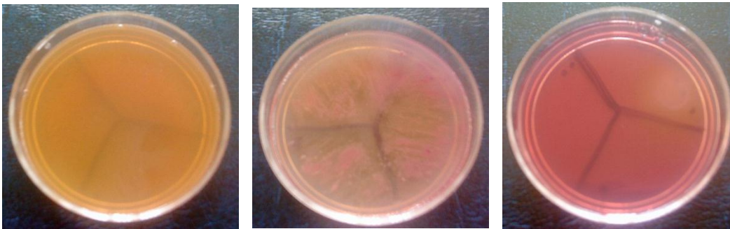
Fig. 46. Plata 0.32%. Evolución del crecimiento de E. coli en las placas izquierda y central a las 48 horas de incubación a temperatura ambiente. En la placa derecha ya se observa la presencia de E. coli .
