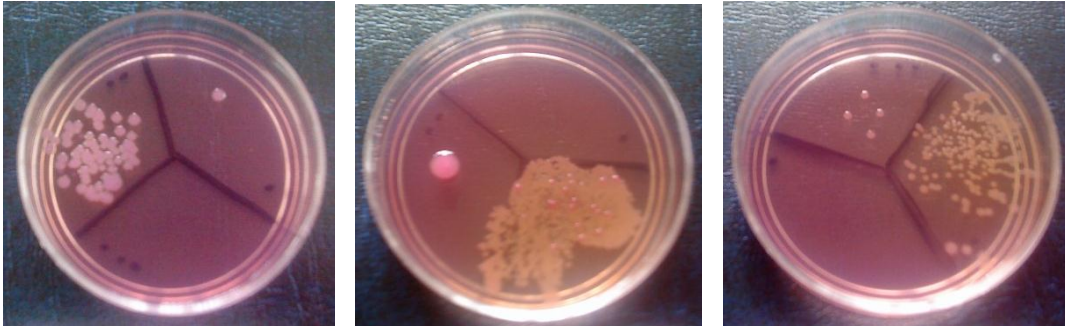
Fig. 27. Plata 0.38% BC. Crecimiento de E. coli en las placas izquierda y central a las 24 horas de incubación a temperatura ambiente. En la placa del lado derecho (colonias color blanco) no se observa presencia de E. coli
