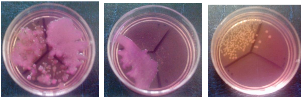
Fig. 25. Plata 0.38% GV. Evolución del crecimiento de E. coli en las placas izquierda y central a las 48 horas de incubación a temperatura ambiente. En la placa del lado derecho (colonias color blanco) no se observa presencia de E. coli
