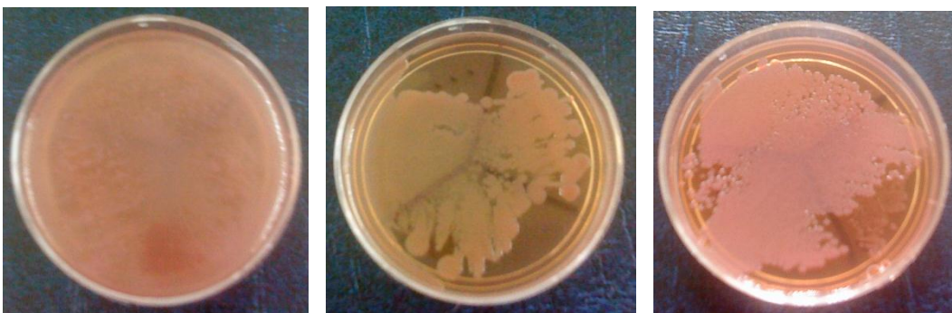
Fig. 50. Plata 0.15%. Evolución del crecimiento de E. coli en las tres placas a las 72 horas de incubación a temperatura ambiente.
