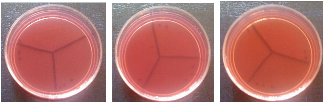
Fig. 61. Monopersulfato 20 \text{ g.L}^{-1} . No se observa crecimiento microbiano a las 48 horas de incubación a temperatura ambiente.
