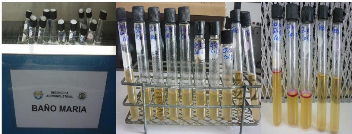
Figura 24. Prueba bioquímica para la producción de indol.
