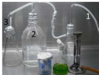
Figura 6. Reactor simple donde: 1 es la entrada para el aire, 2 Medio de cultivo con agitador y difusor de burbujeo y 3 salida del aire.
