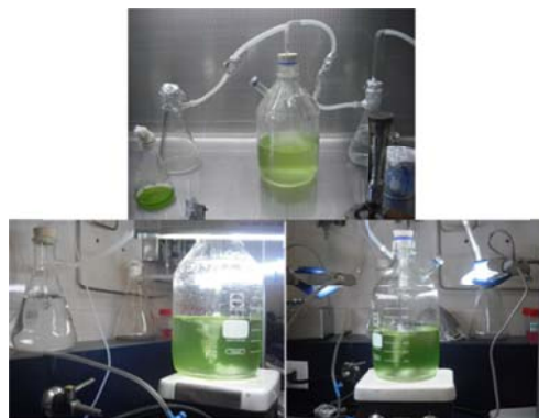
Figura 7. Reactor inoculado con las microalgas y puesto en marcha
