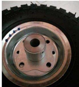
*Figura 47. Buje acoplado a las llantas.*
