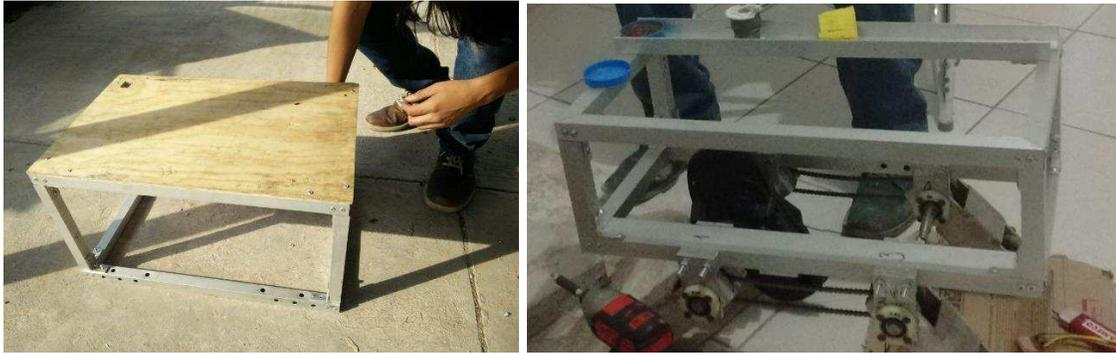
*Figura 45. Estructura principal primer prototipo(izquierda), final(derecha).*
