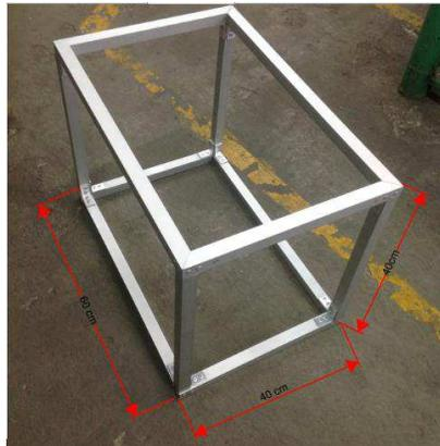
*Figura 13. Chasis del primer prototipo.*
