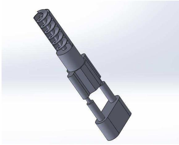
*Figura 31. Diseño conceptual actuador para microlabranza.*
