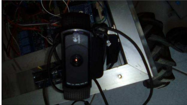
*Figura 42. Cámara Logitech c920 utilizada, en el sistema de visión.*
