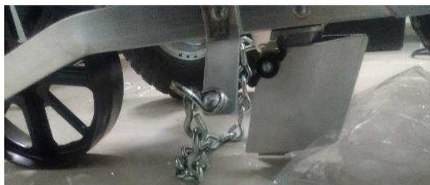
*Figura 33. Abridor y cadena de la sembradora Earthway 1001b.*
