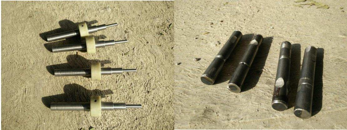
*Figura 48. Ejes motriz a la salida de la reducción del motor, con buje(izquierda).
