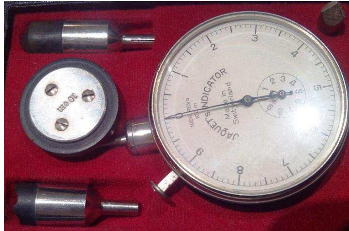
Figura 24. Tipo de tacómetro utilizado analógico y de contacto.
