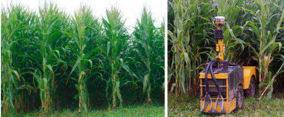
*Figura 10. Rowbot, robot agrícola para la aplicación de nitrógeno en maíz.*
