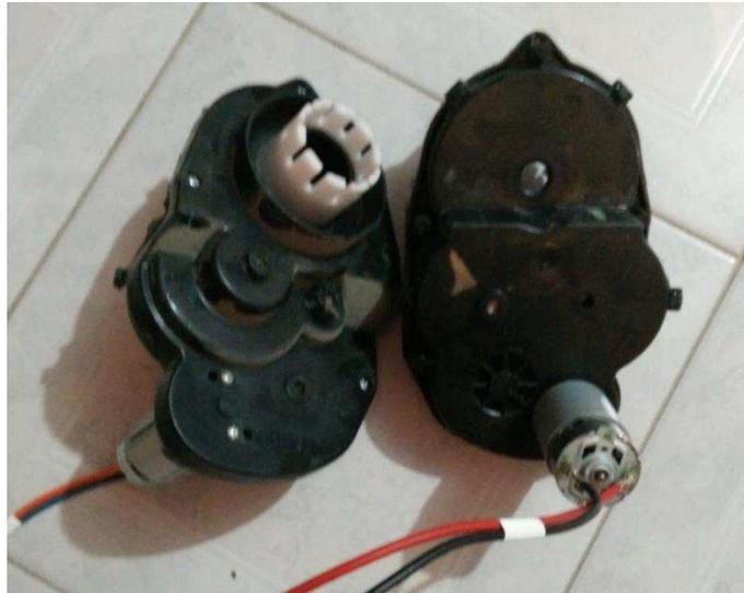
*Figura 23. Motorreductores seleccionados.*
