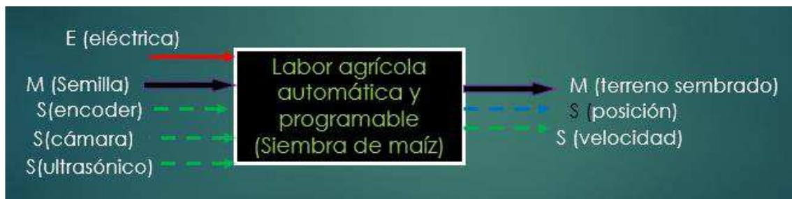
Figura 11. Diagrama de la función principal o global.
