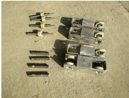
*Figura 49. Brazos de soporte de las ruedas y la transmisión.*
