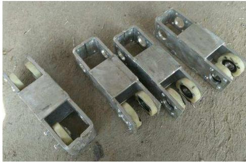
*Figura 46. Bujes, rodamientos y brazos de soporte de las ruedas.*
