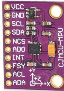
Figura 43. IMU MPU 9250.
