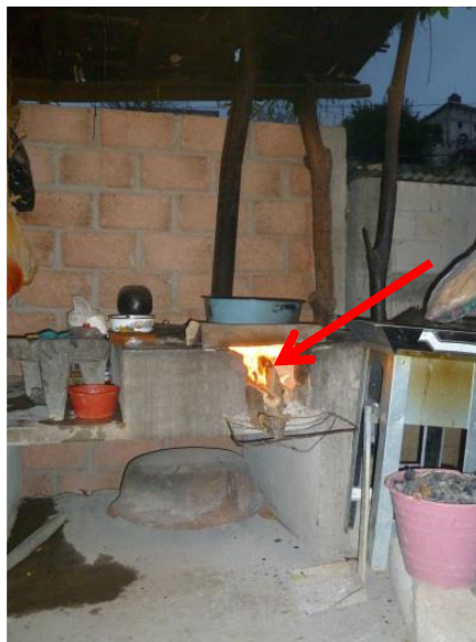
Figura 7. Modificación de la entrada de leña a la estufa Lorena.
