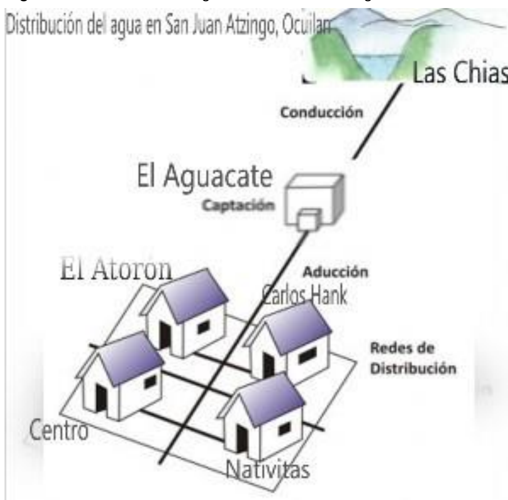
Figura 13 Distribución de agua en San Juan Atzingo, Ocuilan.
