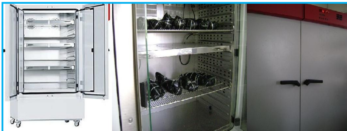
Figura 3.- Cámara climática con luz y temperatura constantes KBW-72.
