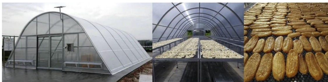
Figura 2-8. Secado de plátano en el interior de un secador solar tipo invernadero con cubierta de policarbonato (Udomkun et al. , 2020).
