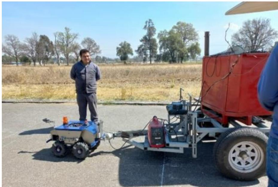
**Figura 3.9** Celda de carga acoplada entre el robot y el remolque.
