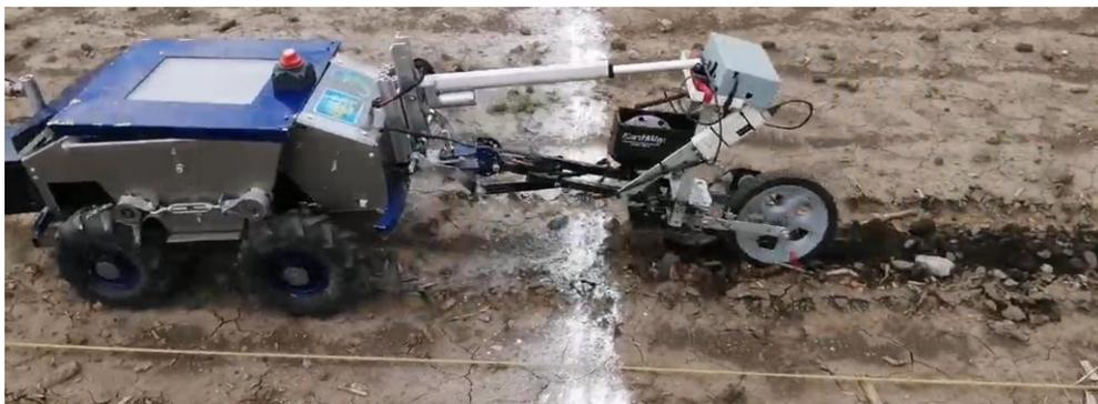
**Figura 3.12** Robot con implemento de sembradora en la prueba de siembra.
