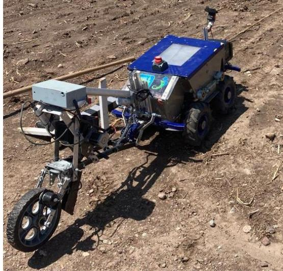
**Figura 2.4** Robot Voltan con implemento de siembra.
