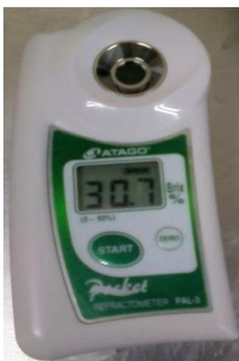
**Figura 7.** Refractómetro utilizado para medir sólidos solubles totales.
