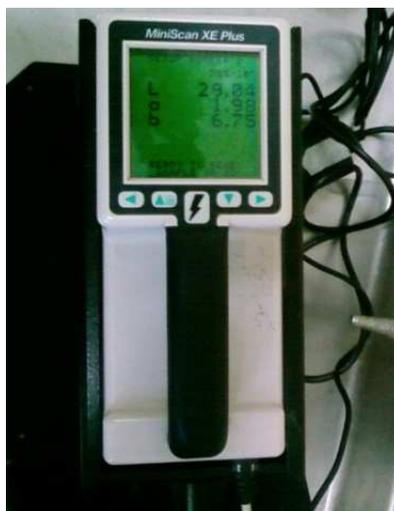
**Figura 6.** Colorímetro utilizado para medir el cambio de color de los frutos.
