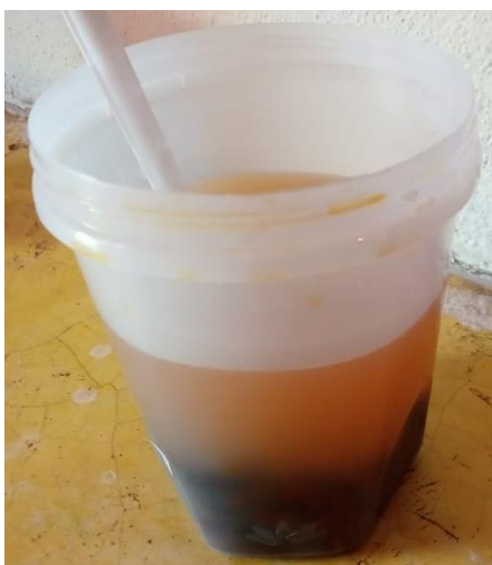
Figura 20. Semillas reposando en hidróxido de sodio (NaOH).
