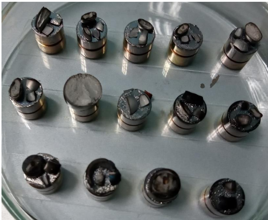
Figura 8. Muestras recubiertas con oro-paladio.
