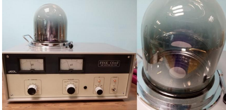
Figura 7. Sputter realizando recubrimiento en muestras.
