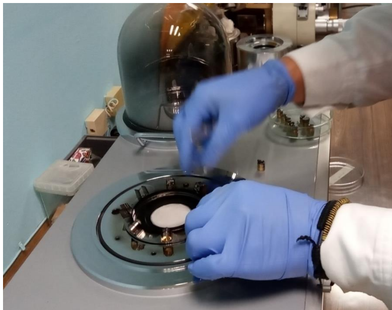
Figura 6. Colocación de muestras en el Sputter.
