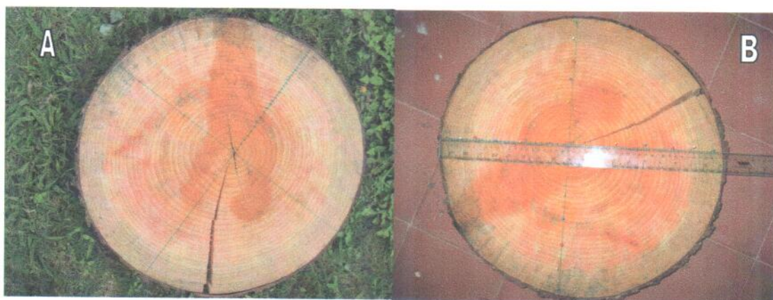
Figura 5. Medición de anillos de crecimiento. A. Trazo de ejes perpendiculares, B. Delimitación de periodos de crecimiento.
