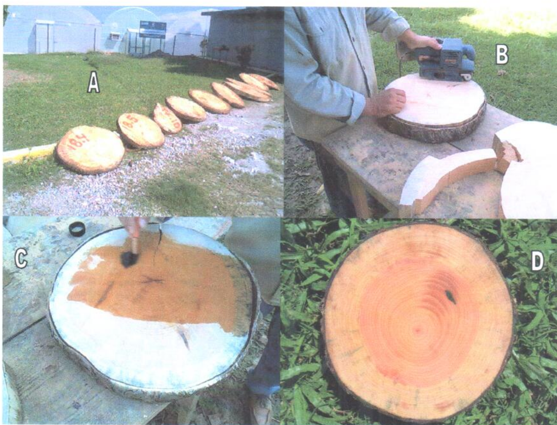
Figura 4. Proceso de preparación de rodajas de madera. A. Secado al aire libre, B. Pulido de superficie, C. Contraste de anillos de crecimiento, D. Visualización de la circunferencia completa del anillo.
