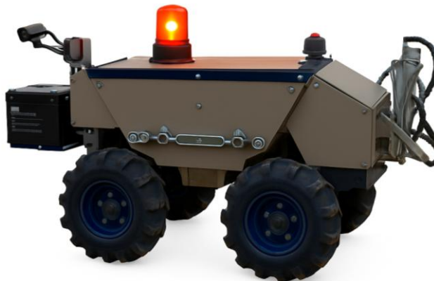
Figura 11. Robot agrícola empleado en las pruebas: chasis de aluminio, dos motores DC y batería \text{LiFePO}_4 de 12 V–50 Ah.
