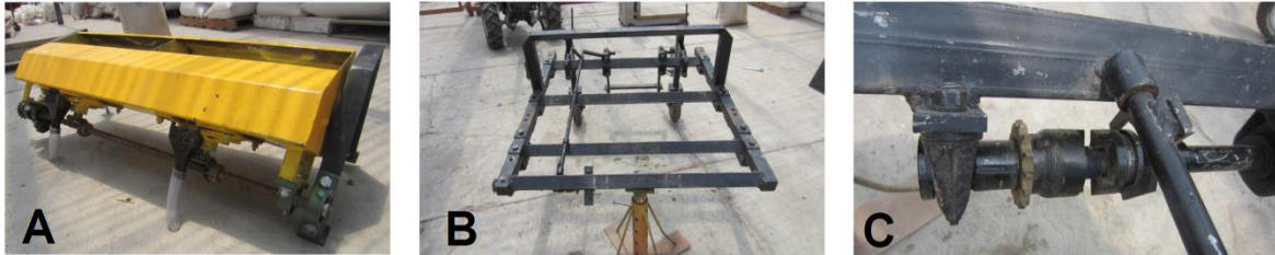
Figura 56. Construcción del prototipo. A) Tolva para semillas, B) Chasis, C) ensamblaje del embrague.
