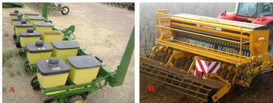
Figura 13. Tipos de tolvas para semilla y fertilizantes, A-para cada línea de siembra; B-única para todas las líneas de siembra.
