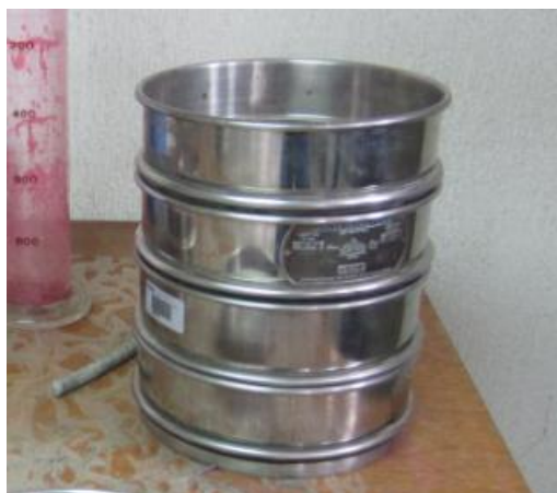
Figura 27. Torre de tamices para determinar la distribución de tamaño del fertilizante.
