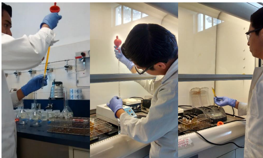
Figura 12. Pasos de la DQO. a) Vertido de dicromato b) Vertido de sulfato de plata c) Inversiones de tubos y tubos colocados en digestor.
