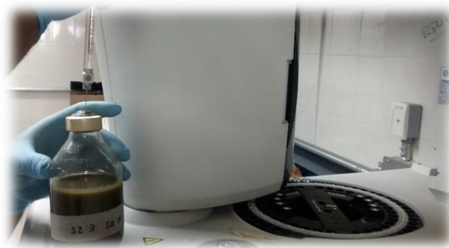
Figura 13. Toma de muestra e inyección en cromatógrafo.
