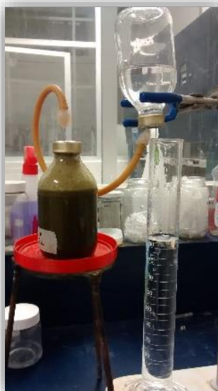
Figura 11. Medición de biogás por desplazamiento de agua.
