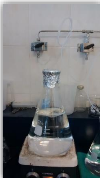
Figura 7. Matraz Erlenmeyer con agua destilada y flujo constante de nitrógeno.
