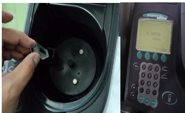
Figura 15. Medición de absorbancia a 415 nm para flavonoides, de las muestras de xoconostle, en un espectrofotómetro Genesys 10s.
