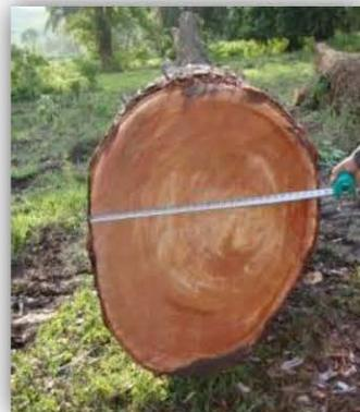
FIGURA 7. MEDICIÓN DEL DIÁMETRO DE LA TROZA
