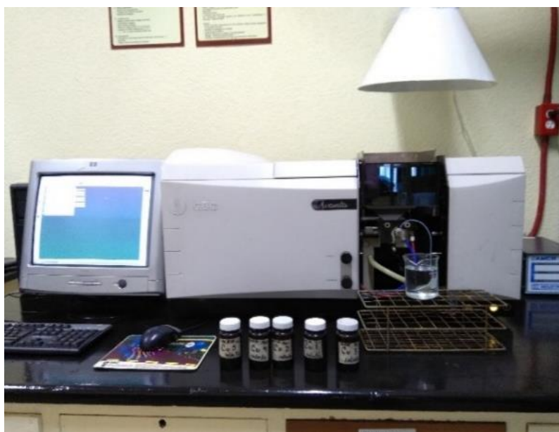
Figura 5. Determinación de micronutrientos en un espectrofotómetro de absorción atómica AVANTA GBC®.
