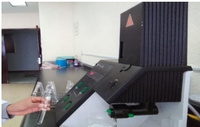
Figura 4. Determinación de cationes en un fotómetro de llama Sherwood M410.
