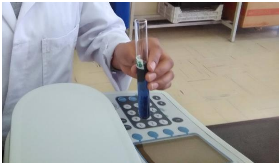
Figura 3. Determinación de fósforo en un espectrofotómetro GENESYS 10UV®.
