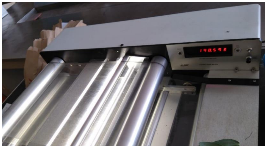
Figura 6. Medición de área foliar en plantas de lisianthus, con un integrador de área foliar LI-COR 3100
