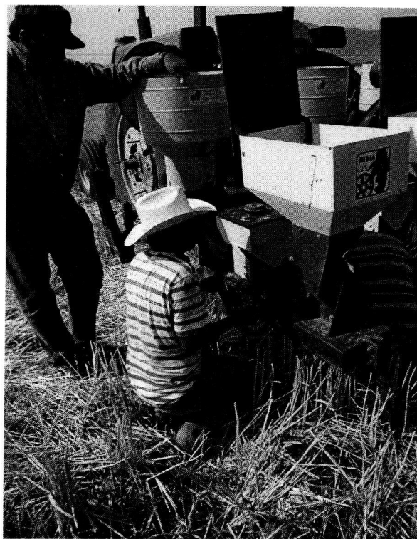
Foto 1. Ajustando la sembradora
