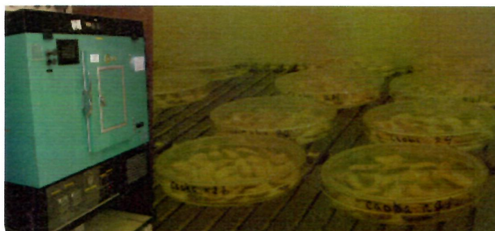
Figura 14. Cámara de ambiente controlado marca Convion, a un régimen de temperatura diaria de 28/24 °C día/noche y 12 h de luz.
