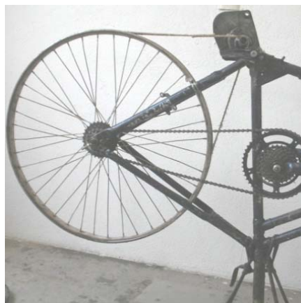
Figura 36. Transmisión rueda deshumidificadora
