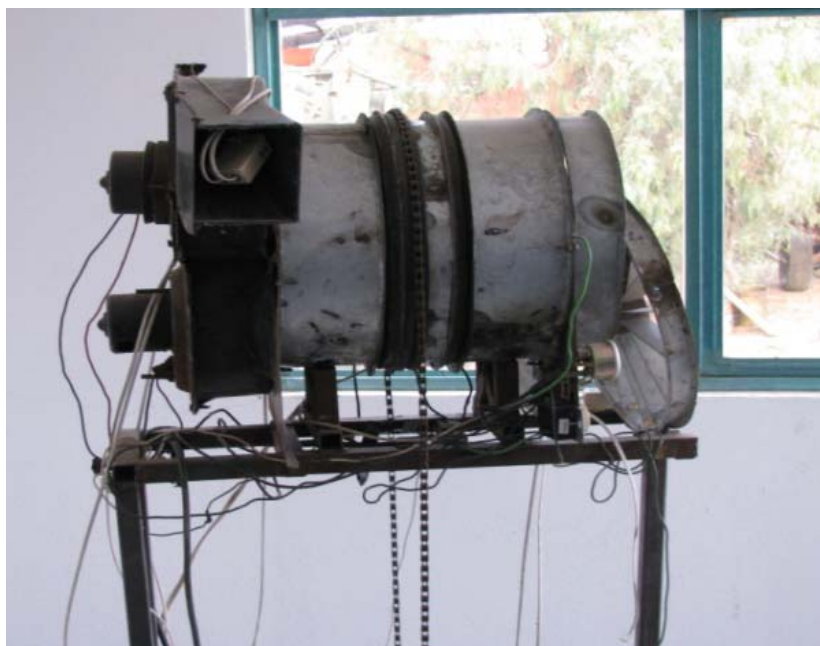
Figura 45. Banco de prueba del deshumidificador
