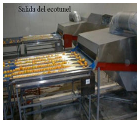
Figura 24. Sistema de secado "ECO túnel"
