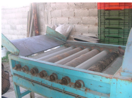
Figura 21. Problema de obstrucción de rodillos
