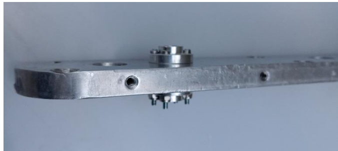
Figura A14. Eslabón 2 con acopladores instalados.
