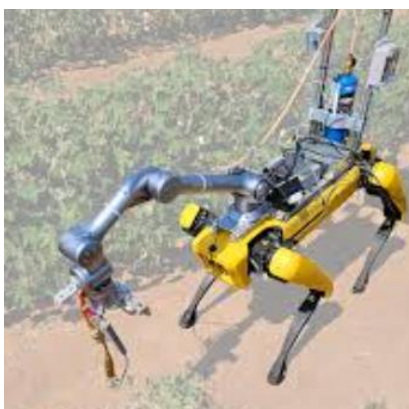
Figura 3. Móvil para eliminar malezas con un lanzallamas tomado de Wang et. al (2024)
