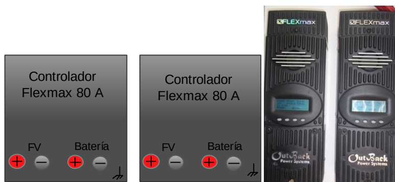
Figura 47. Conexiones del sistema de regulación
