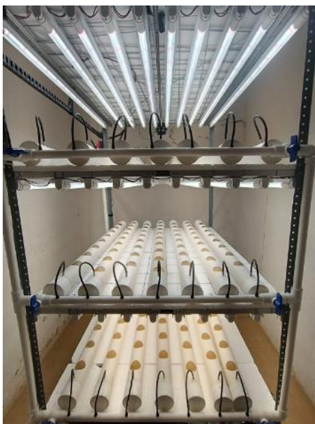
Figura 3.22. Estructura de la mini-PFAL con sistema hidropónico tipo NFT y arreglo de luminarias LED (vista frontal).
