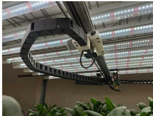
Figura 3.8. Robot cartesiano para la captura de imágenes.
