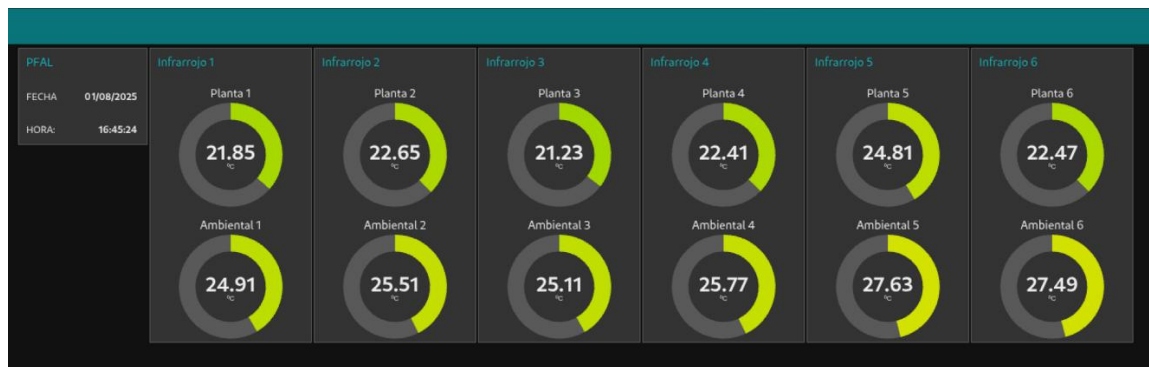
Figura 3.10. Panel de sensores infrarrojos: se presentan las lecturas de temperatura de planta y de temperatura ambiental de cada sensor MLX90614.
