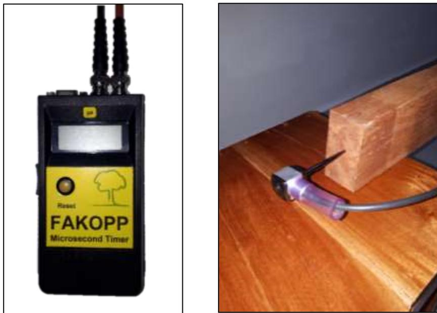
**Figura 7.** Fakopp & Sensor acoplado a un extremo de la viga.
