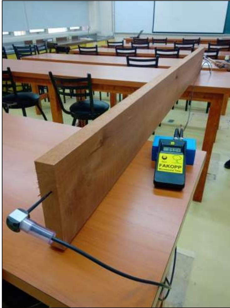
**Figura 8:** Ensayo del módulo de elasticidad por ultrasonido con Fakopp.
