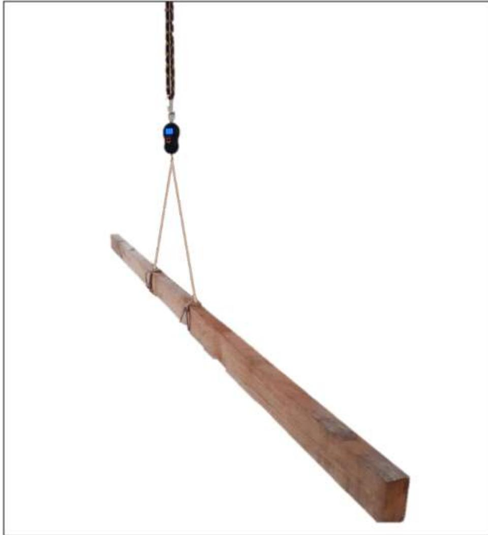
**Figura 3.** Obtención del peso de las probetas.
