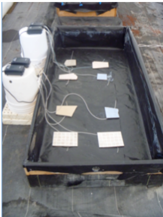
Figura 8. Recubrimiento interior del cajón para hidroponía de flujo profundo.
