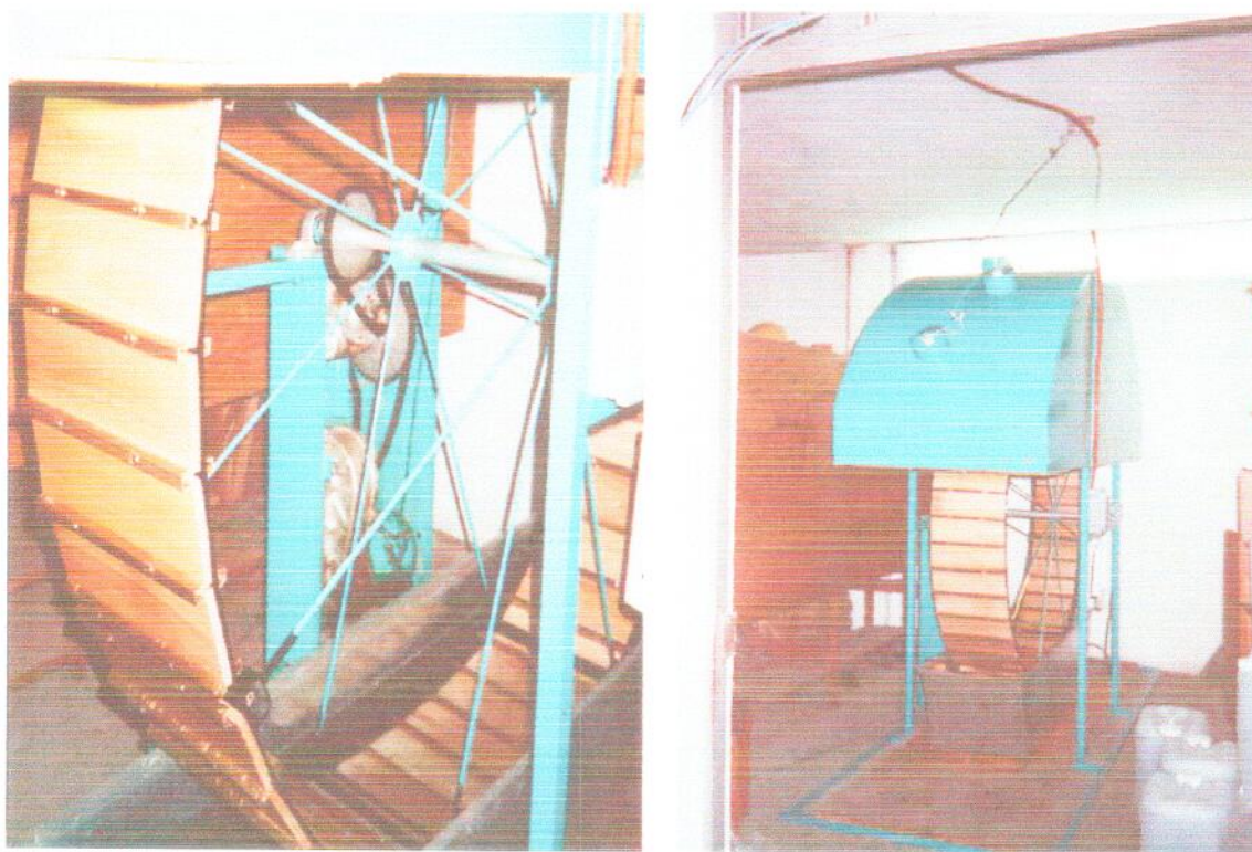
Figura 6. Probetas colocadas en el equipo de intemperismo acelerado.
