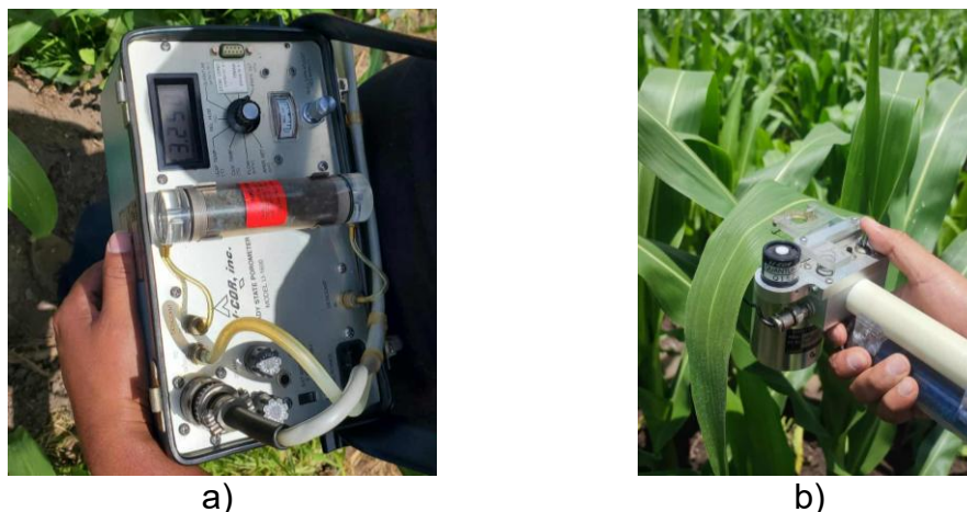
Figura 24. a) porómetro de estado estacionario LI-COR LI-1600, b) Cámara tipo pinza
