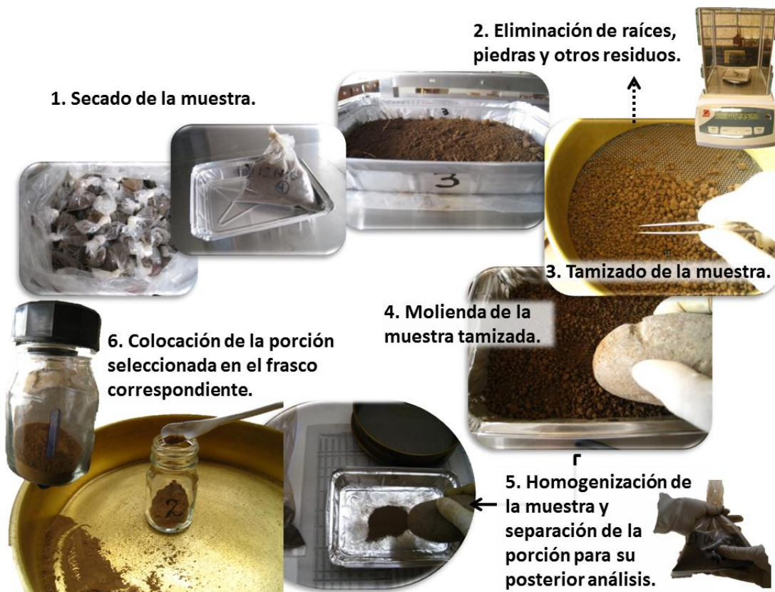
Figura 24. Preparación de las muestras en laboratorio para determinar el carbono del suelo.
