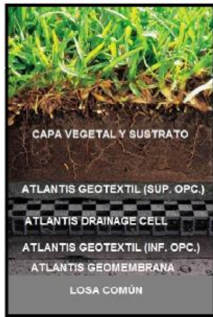
Figura 17. Sistema Atlantis para instalación de jardines en azoteas (Atlantis, 2011).
