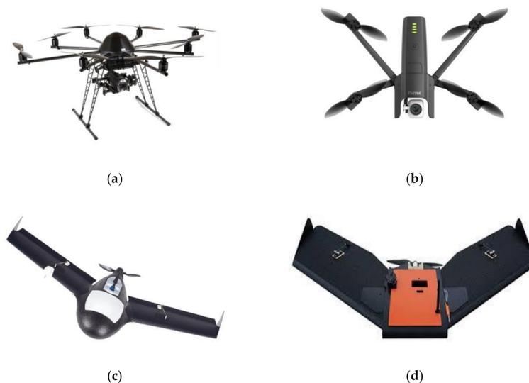
**Figura 2.1:** Ejemplos de RPAS comerciales utilizados en la agricultura de precisión: (a) MK Okto XL 2 de ocho rotores (b) Parrot Anafi de cuatro rotores, (c) Gatewing X100 y (d) Tuffwing Mapper. Recuperado de del Cerro, Cruz Ulloa, Barrientos y de León Rivas (2021)
