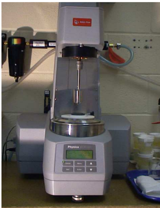
Figura 17. Reómetro empleado en la determinación de las curvas de flujo
