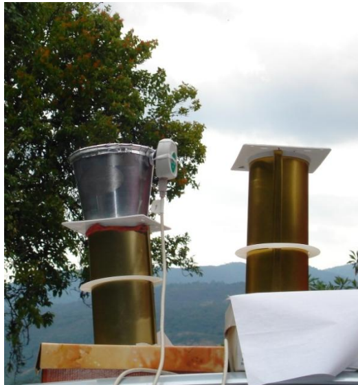
Figura 27. Configuración 1: Luminoducto con concentrador y sin concentrador. Longitud de 280 mm y 101.6 mm de diámetro.
