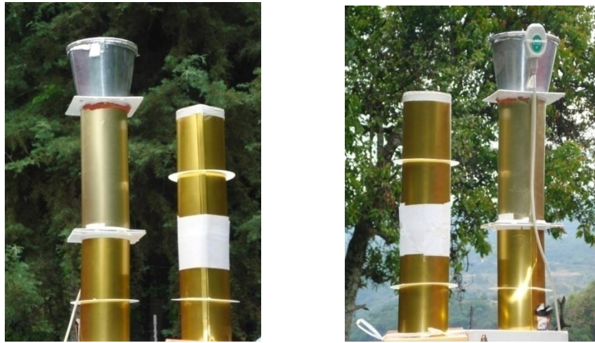
Figura 28. Configuración 2: 2 Luminoductos con concentrador y sin concentrador. Longitud de 560 mm y 101.6 mm de diámetro.
