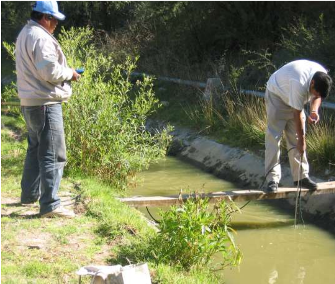
Figura 4.6. Medición del caudal en el canal lateral 5 margen izquierdo.
