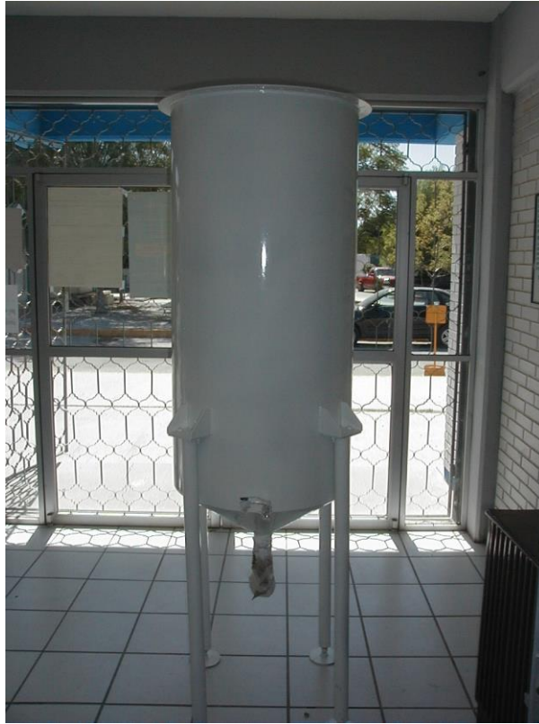
Anexo 1. Biorreactor armado.
