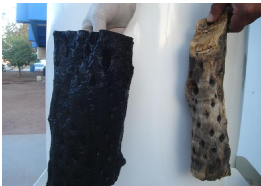
Anexo 6. Formación de la biopelícula en el cardenche por la coloración negra que se observa en la pieza del lado derecho.
