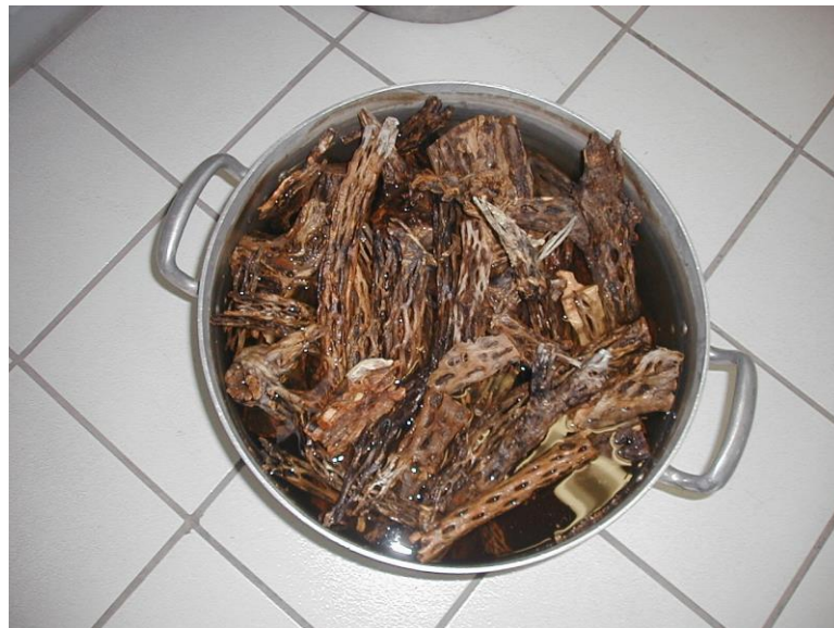
Anexo 2. Limpieza de cardenche para eliminar impurezas en el soporte de la biopelícula
