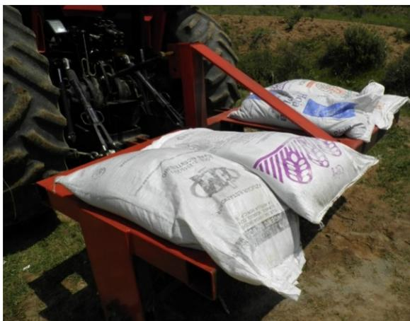
**Figura 5.6. Adición de contrapesos sobre el rodillo aireador.**
