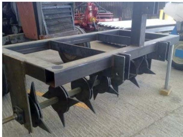
(b) Estructura para acoplar el rodillo aireador al enganche de tres puntos del tractor.
