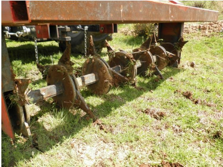
**Figura 7.6. Rodillo aireador en operación en el campo.**
