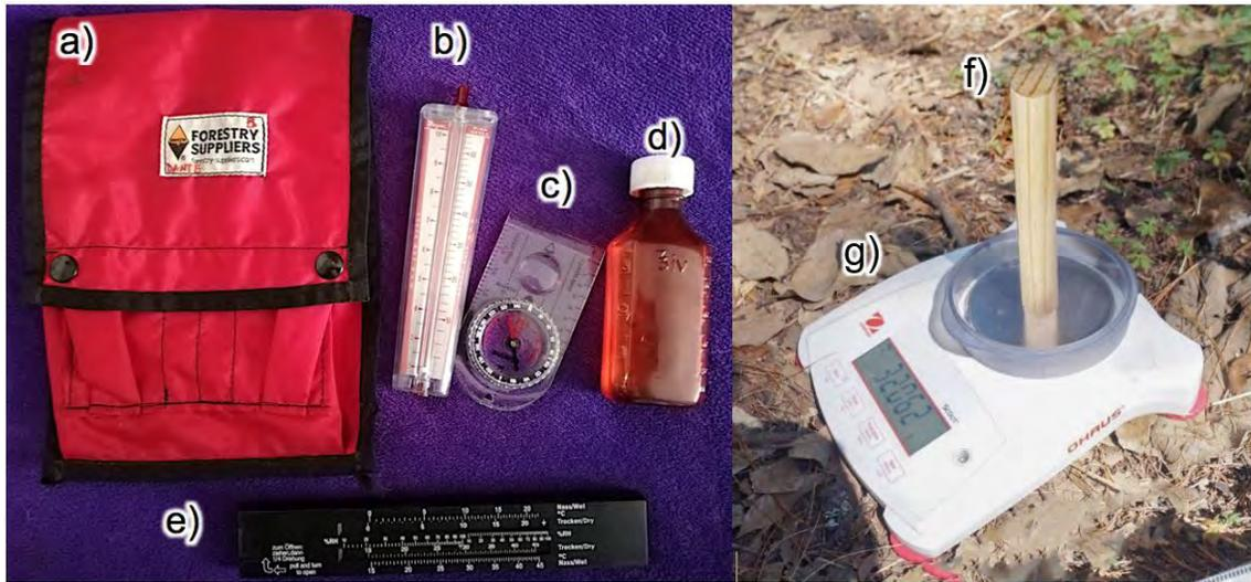
Figura 6. Equipo empleado para la medición de variables meteorológicas y para la determinación del contenido de humedad de los combustibles leñosos. Componentes del estuche meteorológico portátil: a) funda, b) anemómetro de bolsillo, c) brújula, d) agua destilada, e) psicrómetro de bolsillo; f) probeta de Pinus patula y g) báscula digital.
