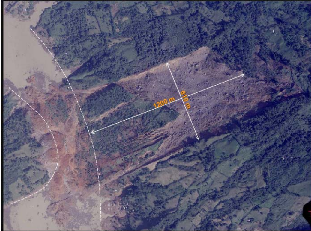
Foto II.1.1. Dimensiones del Deslizamiento
