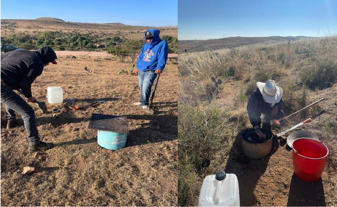
Figura 19. Pruebas de infiltración.
