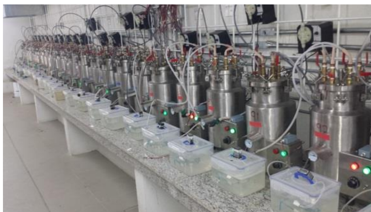
Figura 13. Digestores anaeróbicos en el Laboratorio de Bioprocesos. Universidad Autónoma Chapingo.
