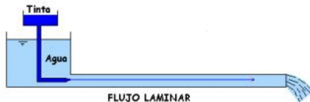
Figura 22. EL flujo laminar se presenta para Re < 2000
