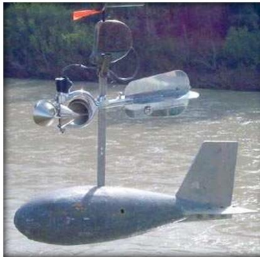
Figura 15. Medición mecánica (molinete tipo Price para altas velocidades)
