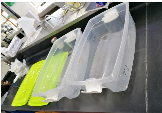
Figura 18. Contenedores usados para cámara húmeda.
