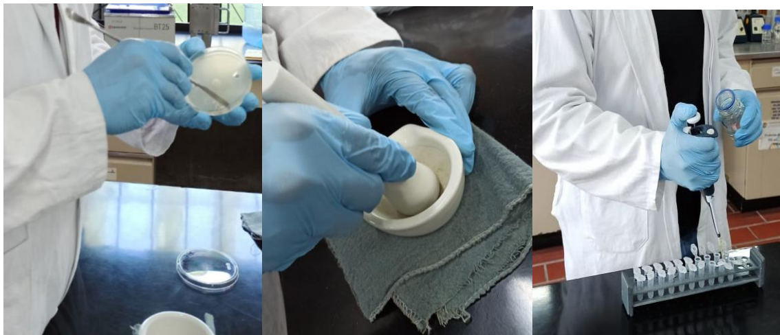
Figura 29. Transferencia de micelio a mortero, y su posterior maceración; preparación de reactivos para extracción.
