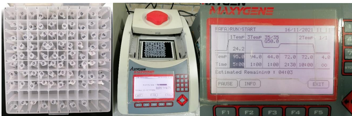
Figura 33. Reacciones para introducir en el termociclador, y su posterior programación.
